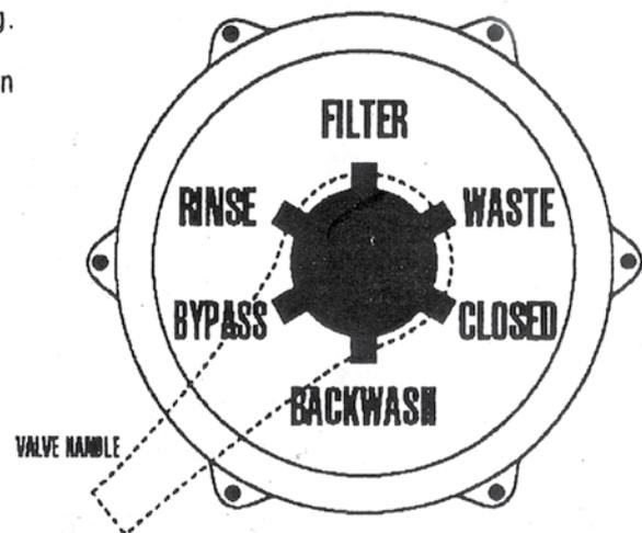
**NEVER MOVE THE VALVE HANDLE POSITION, WHEN THE PUMP IS RUNNING**
